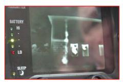
Eine Wärmebildkamera erkennt sehr geringe Temperaturunterschiede (ab 0,05 °C). Dadurch können Feuerwehrleute schon von außerhalb eines Gebäudes Dinge und Gefahrenpotentiale erkennen die dem menschlichen Auge verborgen bleiben. Zum Beispiel kann man die Hitzestrahlung sehen, die ein Brand aus dem Inneren eines Gebäudes nach außen geleitet hat. Oder man kann an den Fenstern erkennen dass es im Inneren sehr heiß ist und sogar unterscheiden in welchem Teil des Gebäudes der Brandherd zu suchen ist.
