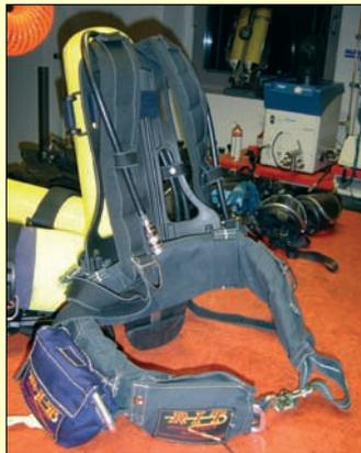
**rettungssystem:** Im Beckengurt des Pressluftatemschutzgerätes ist die Notabseilvorrichtung integriert.
